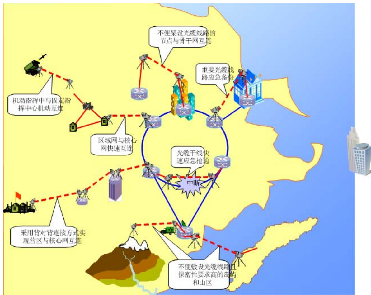
图4 大气激光通信系统综合应用
