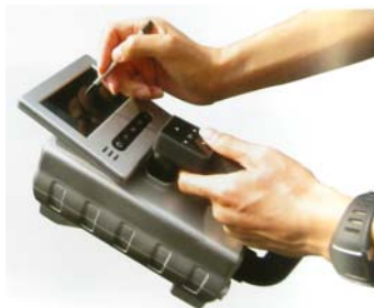
图 1 NPS-L1 型数字化便携式 \gamma 谱仪
